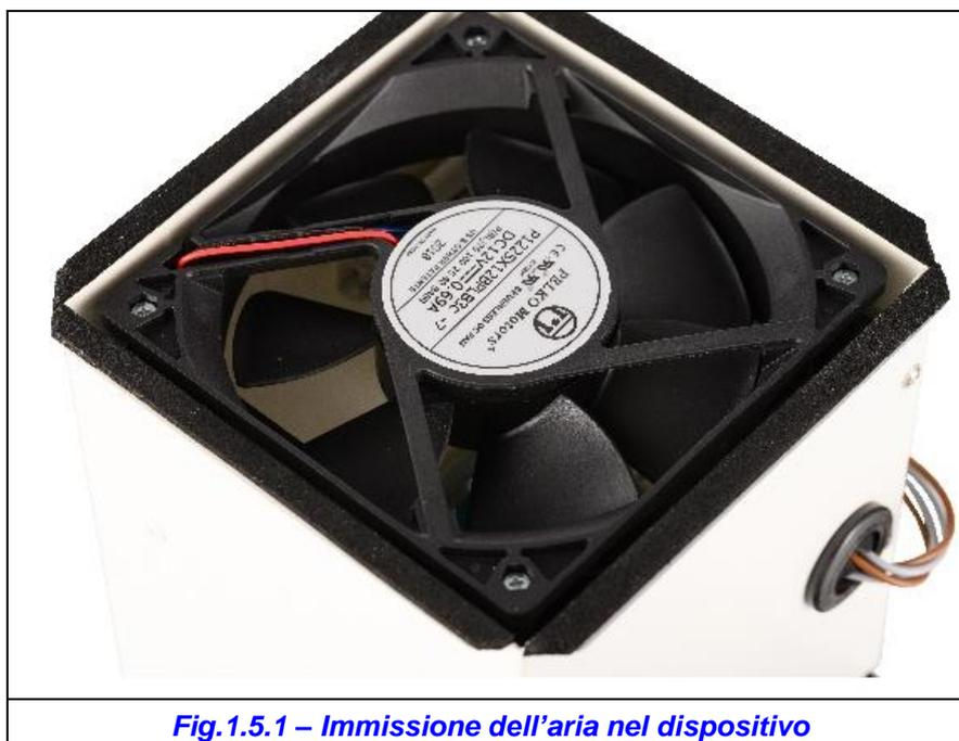
L'aria viene immessa nel sistema di sanificazione attraverso una ventola ([Fig.1.5.1](#)). Una volta entrata nella camera di sanificazione l'aria viene depurata, diventando aria pulita, ove la carica batterica e microbica viene drasticamente abbattuta dalla azione della fotocatalisi prodotta dai componenti del dispositivo (lampada UV + fotocatalizzatore in biossido di
