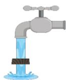
*Rimosso il filtro dal proprio alloggiamento, utilizzare un getto di acqua calda per rimuovere ulteriori residui ed asciugare con un panno. Si sconsiglia l'uso di detergenti aggressivi che possano eventualmente danneggiare le parti interne della macchina. Il filtro ricoperto con biossido di titanio è lavabile, ma non in lavatrice o lavastoviglie. Ricordarsi di asciugarlo accuratamente prima di reinserirlo nel proprio alloggiamento.*
